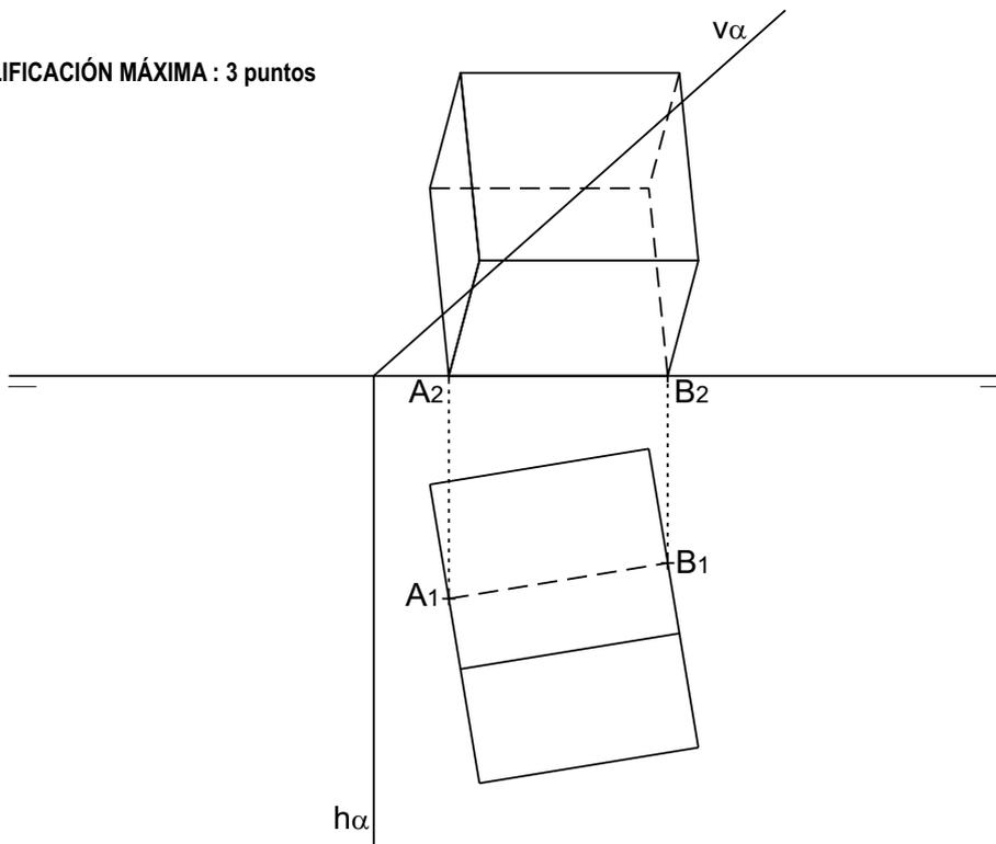
**3B** Dadas las proyecciones diedricas de la figura, dibuja una isometría sin coeficientes de reducción a escala E 1/1. Acota las proyecciones diédricas según la norma UNE.
